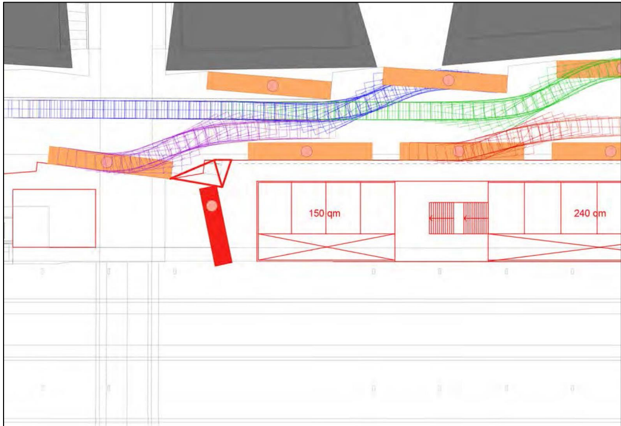
Abb.: Zentrale Anlieferung (rot) für Aufnahmegebäude
