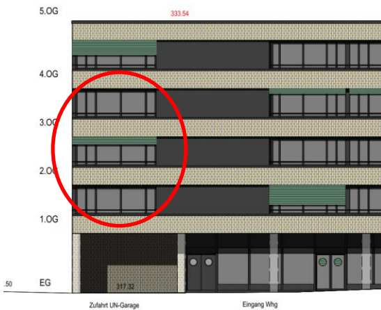
Abbildung 13 Fenster Nordfassade Gebäude A2 mit Planungswertüberschreitungen
