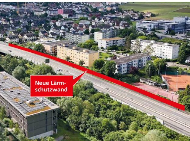
**Im Rahmen des in Projektierung befindlichen Erhaltungsprojekts Anschluss Liestal Nord–Anschluss Lausen wird, als vorgezogene Massnahme, im Bereich Tennisclub Liestal/Ergolzstrasse 1 bis 13 eine Lärmschutzwand entlang der Fahrbahn in Fahrtrichtung Sissach erstellt.**
