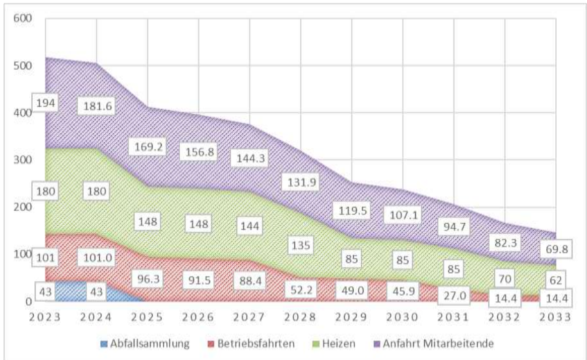
Abbildung 9: Absenkpfad durch Umstellung des Heizens, der Fahrzeuge auf E-Antrieb und klimaneutraleres Pendelverhalten.
