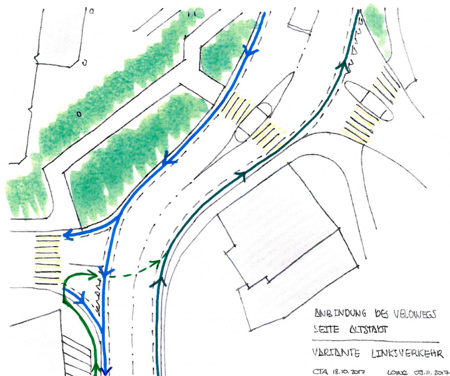
Abbildung 4: Anbindung baulich abgetrennter Veloweg aus SU Oristalstrasse (ausserhalb unterem Bildrand) an den Soodweg (linke Bildseite)
